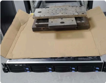
Charge sur le châssis, vue de face
